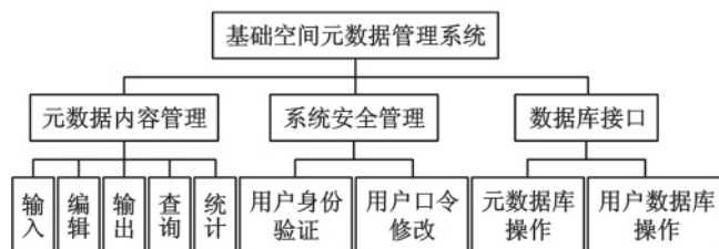
图2 基础空间元数据库管理系统功能结构图
